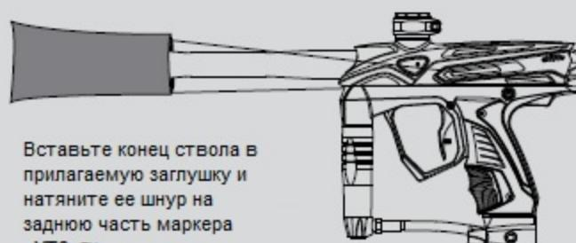
Вставьте конец ствола в прилагаемую заглушку и натяните ее шнур на заднюю часть маркера eXTCy™.
